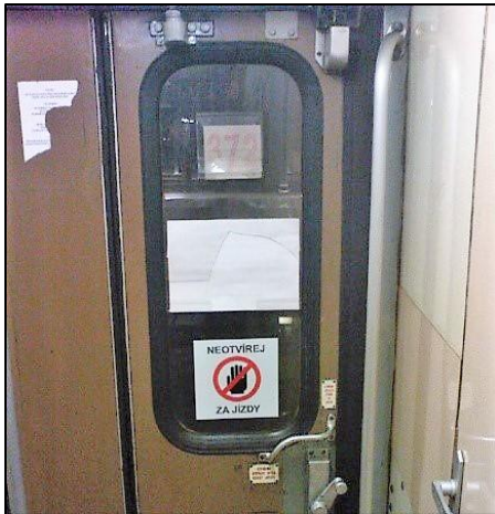
Okno dveří polepené informacemi brání základní orientaci při vystupování
