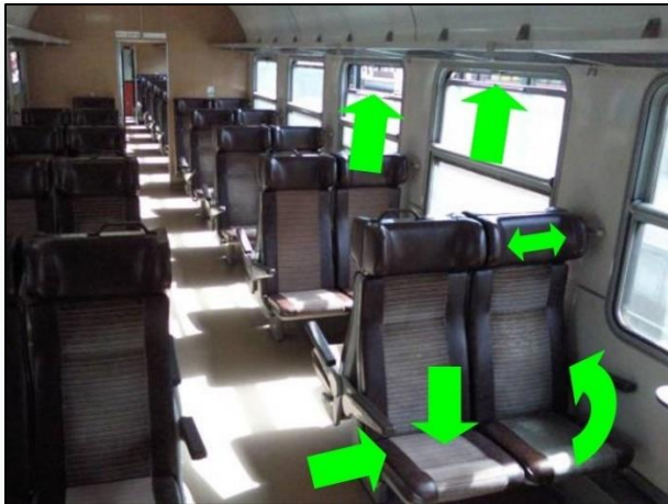
Přednosti interiéru – tvarování, barva a materiál sedadel, možnost zvednutí sedáku při úklidu, možnost zvednutí područky, možnost regulace větrání nastavením okna
